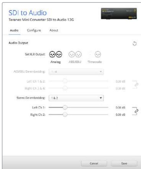
Teranex Setupソフトウェアの「Audio」設定ページでアナログオーディオレベルおよびAES/EBUレベルを調整。
