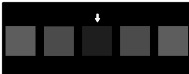
Testmuster zur Kalibrierung von Zeichnung in den Schatten auf Ihrem HDMI-Monitor
