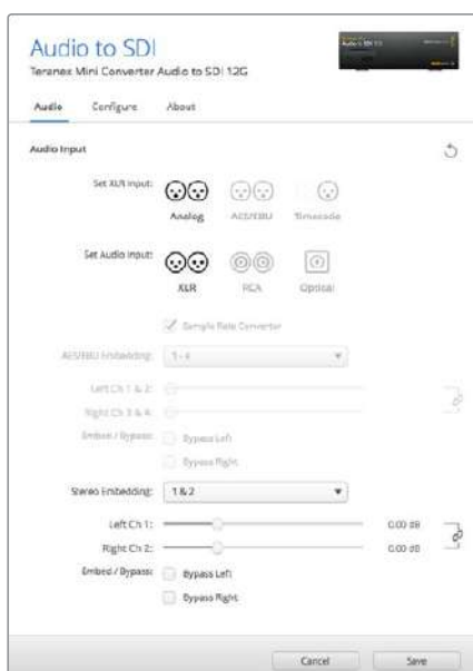
Ajuste de la intensidad del audio analógico o AES/EBU mediante las opciones de la pestaña Audio en el programa Blackmagic Teranex Setup.
