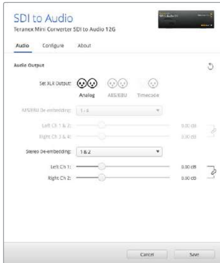
Ajuste de la intensidad del audio analógico o AES/EBU mediante las opciones de la pestaña Audio en el programa Blackmagic Teranex Setup.
