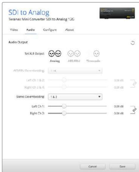
Ajuste de la intensidad del audio analógico o AES/EBU mediante las opciones de la pestaña Audio .
