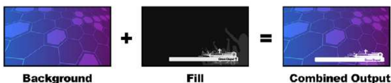
Combinación del fondo y el primer plano en una composición por luminancia
