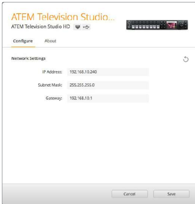
Blackmagic ATEM Setupの「Configure」タブでネットワーク設定を変更します。
