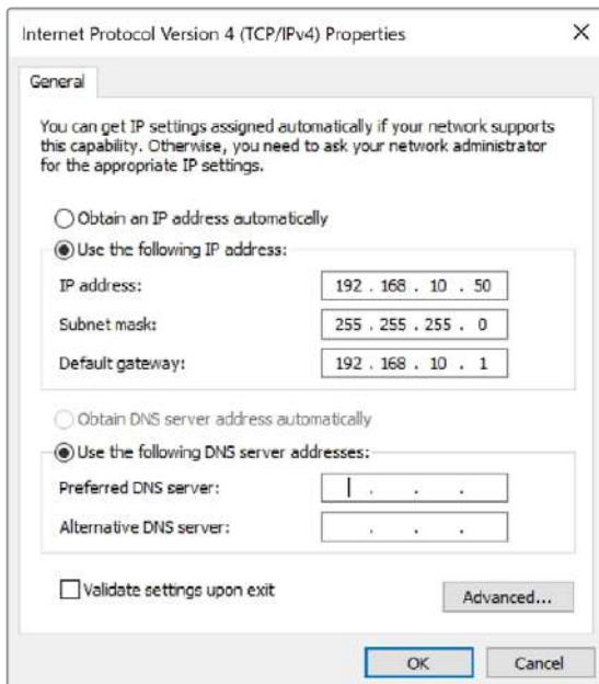
WindowsコンピューターでIPアドレスをマニュアル設定
